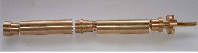
**FIGURE 2:** INSTRUMENTED CYLINDER FEATURING 36 CIRCUMFERENTIAL PRESSURE TAPS.
