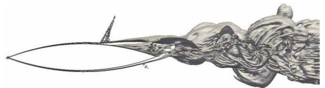
**FIGURE 7:** VORTICITY CONTOURS FROM DES SOLUTION.
